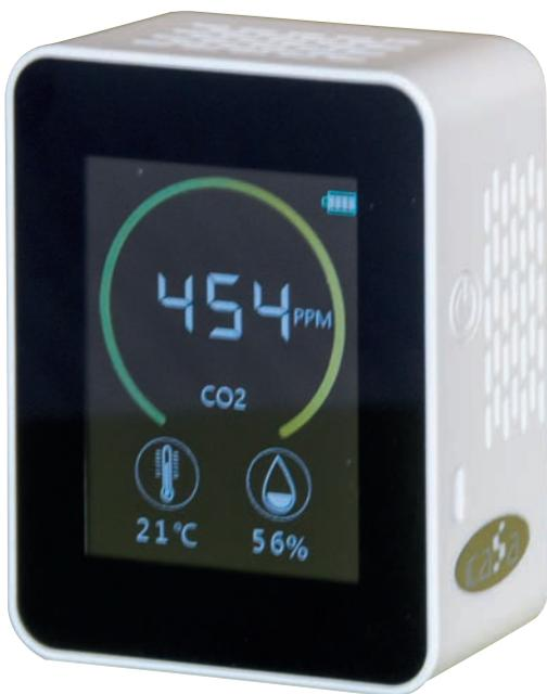
El medidor muestra la concentración de CO<sub>2</sub> en el ambiente, así como la temperatura y la humedad
