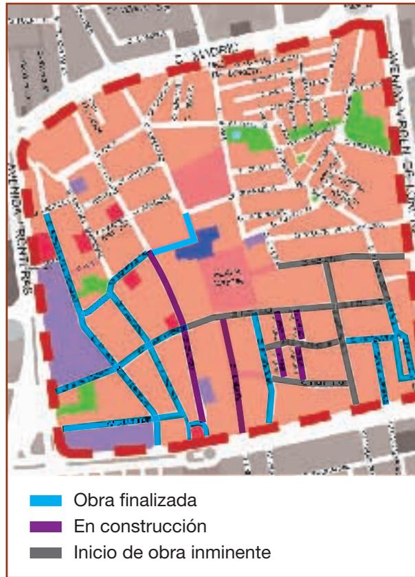
Las obras de remodelación de estas dos calles han consistido en la renovación de todo el pavimento, la instalación de nuevos puntos de luz y la eliminación de las barreras arquitectónicas. Además, los trabajos también han incluido la plantación de césped artificial, así como diferentes plantas y árboles, la mejora del sistema de drenaje de las calles y la construcción de cuatro islas de contenedores soterrados.
