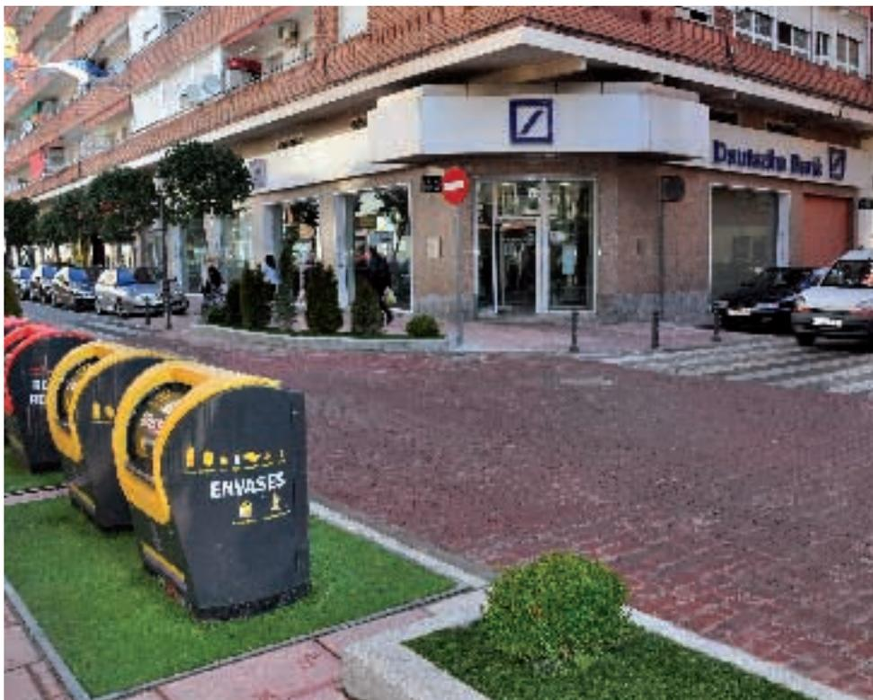
Los trabajos de reforma en la **calle Pesquera** han contemplado la **renovación de todo el pavimento existente en la calle**, ya que el anterior **estaba muy deteriorado y resbaladizo**. Así, se han colocado 580 metros lineales de bordillo, 1.500 metros cuadrados de adoquín para la calzada y 1.540 de baldosa grallada de color rojo y gris.
